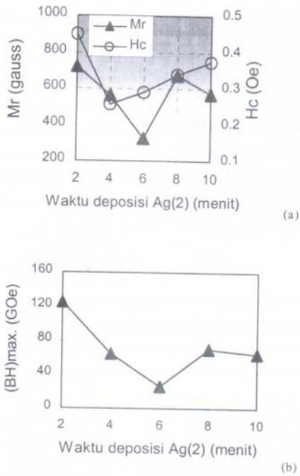
**Gambar 5.** Sifat bahan magnet lapisan Ag/NiFe/Ag/NiFe. (a) kurva M, dan H, (b) Kurva (BH)<sub>x</sub>
